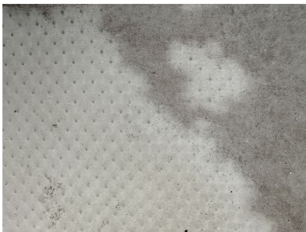
foto /37/ Makroskopický snímek povrchu fólie – světlejší část zasažena bitumenovou korozí (ztráta změkčovadel fólie)
