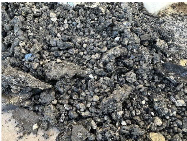
foto /32/ Pohled na vrstvu obalovaného kameniva
